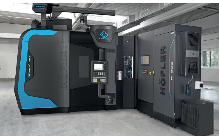
Klingelnberg-Produktionszelle, bestehend aus 'Speed Viper', dem 'CompactLoader' und der 'R 300' © Klingelnberg
